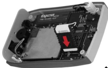
1. Deslize o suporte do SIM Card conforme indicado pela seta até que perceba o sinal de travamento.
