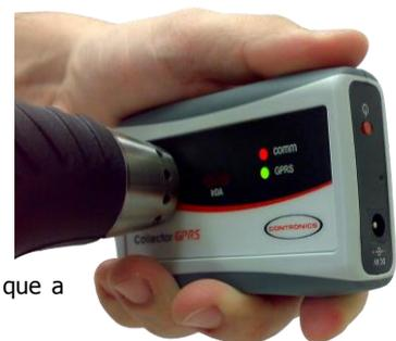
5. Retire o Guardus™ de contato com a interface do Collector GPRS.
