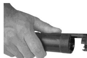
6. Retire as baterias descarregadas e coloque as novas, considerando a polaridade das mesmas.
